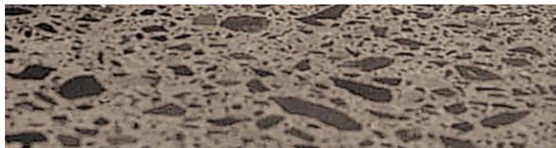
**2.6.1. Definitie:** Beton folosit indeosebi in cazul pardoselilor in scopul obtinerii unei suprafete lise sau chiar lucioase, foarte usor de intretinut. Betonul slefuit se obtine prin slefuirea (frezarea) suprafetei betonului intarit cu ajutorul unor echipamente speciale si al unor agenti de impregnare ce maresc rezistenta suprafetei betonului.
